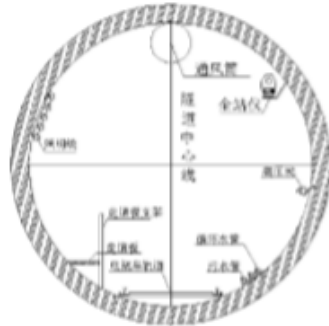
盾构隧道内管线布置示意图
